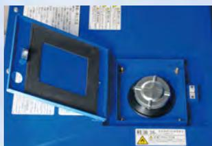
燃料給油の際にこぼれた燃料も新開発の給油口で、一度別桶に受けてからエコベースに流す二重構造で、機外への流出を防ぐことができます。
